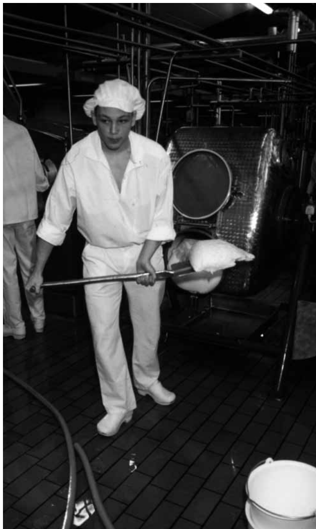
Smørproduktionen på træningsmejeriet i 1989. Smørret tages ud af kærnen og bæres over til pakning. Smørproduktionen kunne både som her foregå på traditionelle anlæg som bueflade eller kubuskærne eller på et kontinuerligt anlæg. På den måde kunne eleverne efterprøve de faktorer, der havde indflydelse på det færdige resultat (Odense Stadsarkiv).
