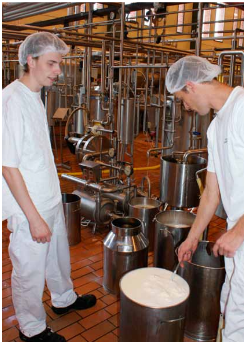
Ved centrifugen tages fløde fra i 2013. Det håndværksmæssige har alle dage været en afgørende del af uddannelsen på skolen. I træningsmejeriet får eleverne større viden om de arbejdsmetoder, der anvendes i mejeriindustrien (Kold College).
